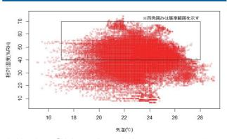
相対湿度とは「特定の温度での水蒸気の分圧と水の平衡気圧の比」のことをいい、いわゆる私たちが日常使っている「湿度」のことです。この図は4事業所/105か所で調べた9:00~18:00の温湿度分布を表しますが、約5割が不適合であったことを示しています。
