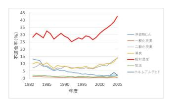
近年温暖化の影響か、二酸化炭素と温度の不適合率が増加するとともに、認識不足のためか相対湿度の不適合率が高い状況です。 『事務所衛生基準規則』では「空気調和設備を設けている場合は、室の気温が17度以上28度以下及び相対湿度が40%以上70%以下になるように努めなければならない」とされています。
